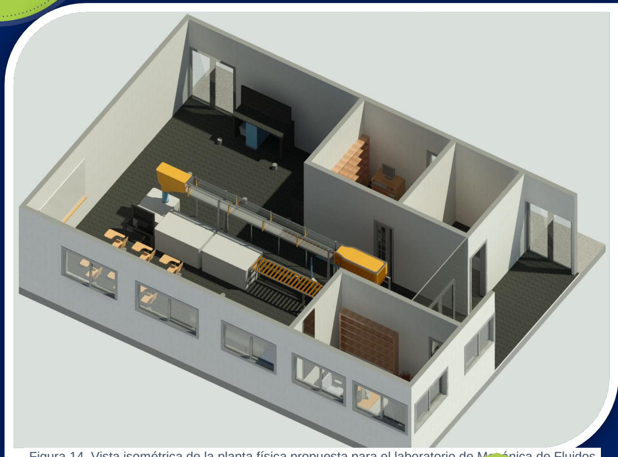
Figura 14. Vista isométrica de la planta física propuesta para el laboratorio de Mecánica de Fluidos e Hidráulica
